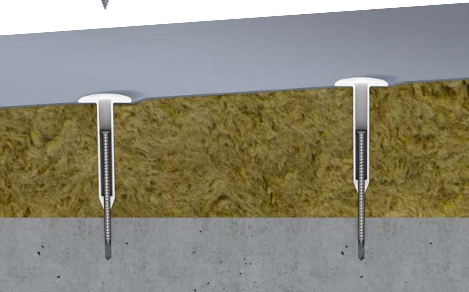
Flachdächer sind in der Regel nicht ganz flach, sondern haben ein leichtes Gefälle, damit Regenwasser gezielt ablaufen kann. Bei einer Gefälledämmung muss der Monteur zur Befestigung der Dichtungsbahn für jede Dämmstoffstärke einen entsprechend langen Befestiger verwenden. Einfacher und wirtschaftlicher sind Flachdachbefestiger, die in der Höhe justierbar sind. Wie beispielsweise der EJOT JBS-R/EcoTek.
