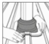
4. DEKTITE® formgenau an Profilblech anpassen.
