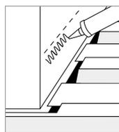
3. Auftragen der Dichtungsmasse unterhalb der Dichtungslinie.
